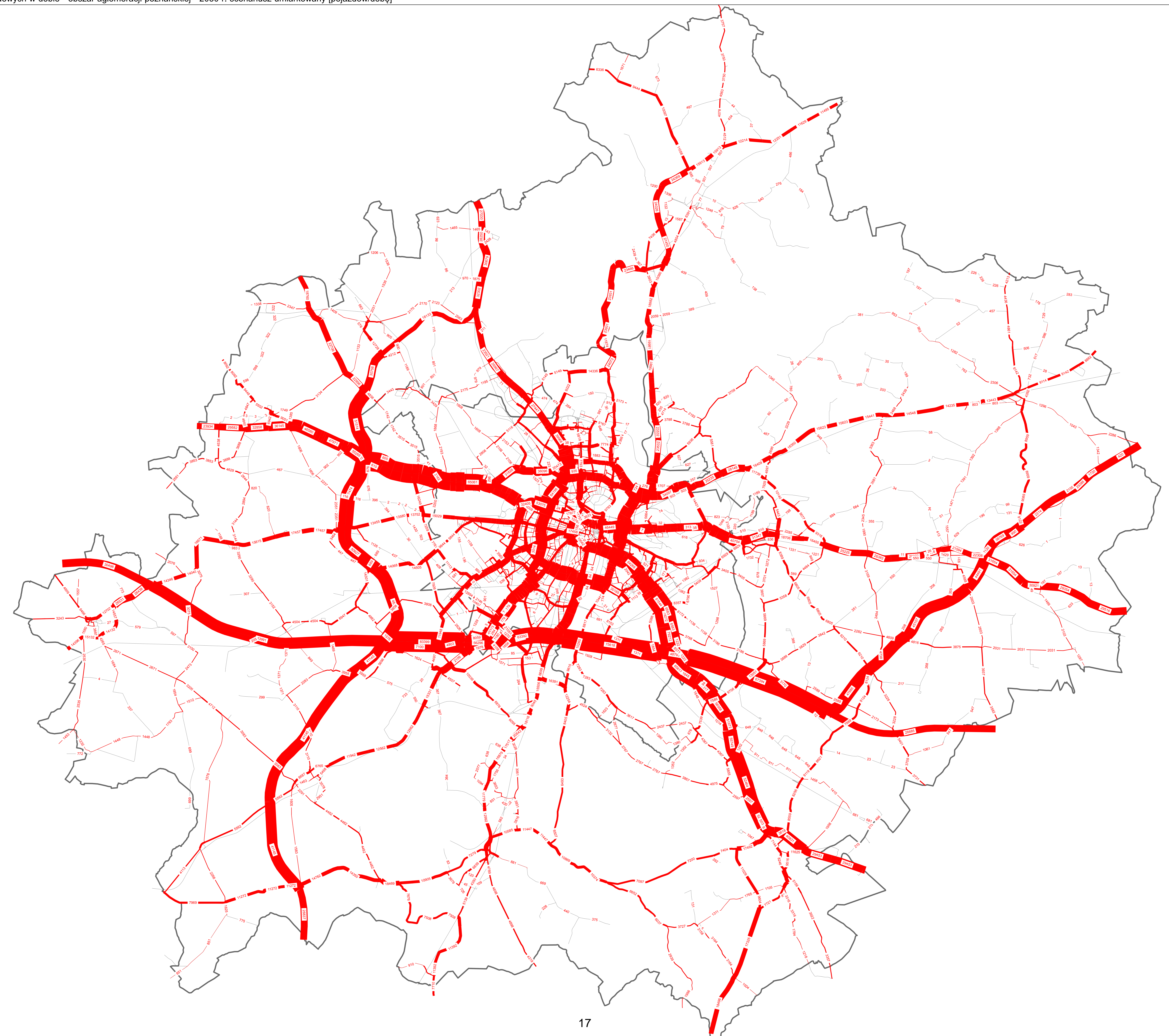
Rysunek 14. Rozkład potoków samochodowych w dobie - obszar aglomeracji poznańskiej - 2030 r. scenariusz umiarkowany [pojazdów/dobę]
